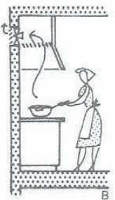
13 Ventilación mecánica mediante un ventilador en la pared exterior (A) o preferiblemente mediante una campana extractora justo encima de la cocina (B)
