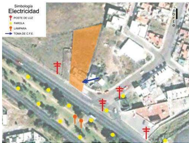
Fig. 84 Ubicación de la infraestructura eléctrica, Elaboró: AMT
