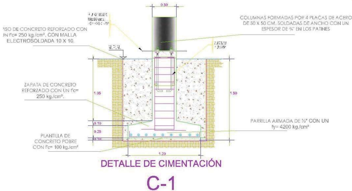
110. Detalle de cimentación propuesta en el proyecto.
