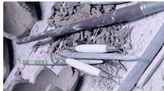
Foto 3, Herramientas utilizadas para darle texturas y hacerle figures en relieve a las piezas, Foto RMH.
