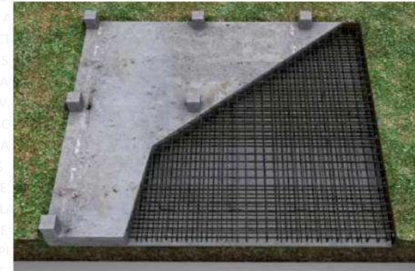
67.- MODELO VIRTUAL DE LOSA DE CIMENTACION.
