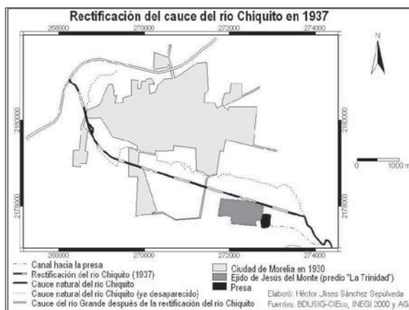
Imagen 54. Muestra la rectificación del río chiquito realizada en 1937 y su cauce natural (Previo a la rectificación).
