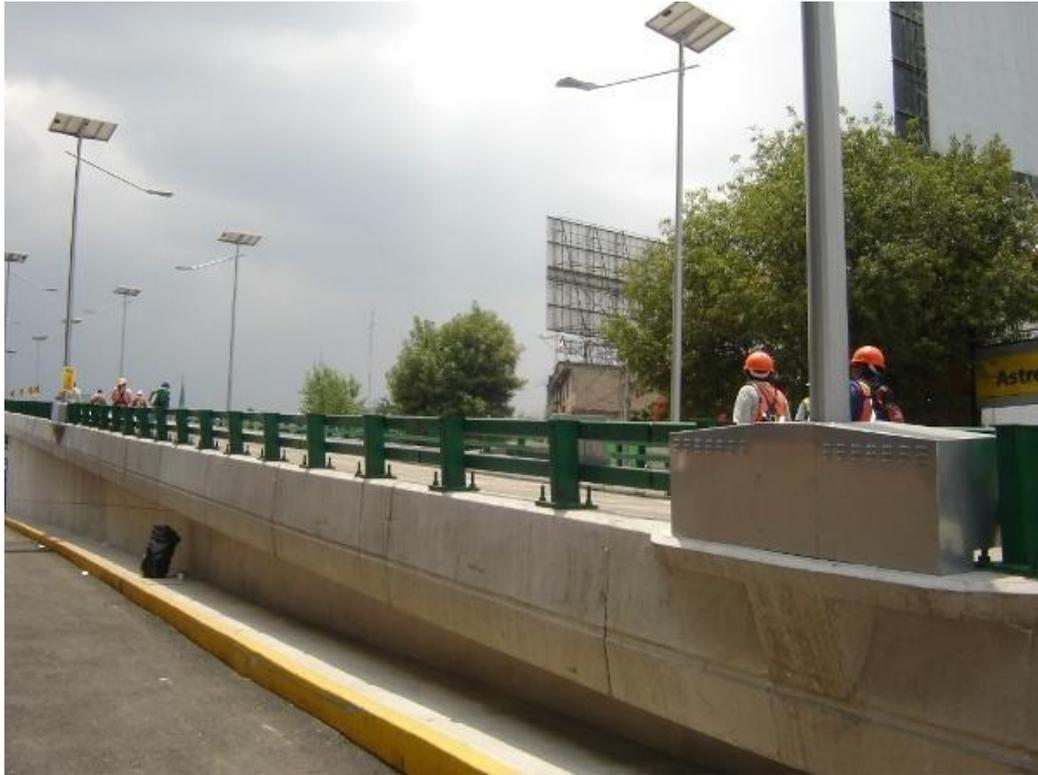
Fig. 29 Luminarias LED con paneles fotovoltaicos. Fuente: <http://www.iluminet.com.mx/alumbrado-ecologico-en-el-viaducto-elevado-periferico-norte/>
