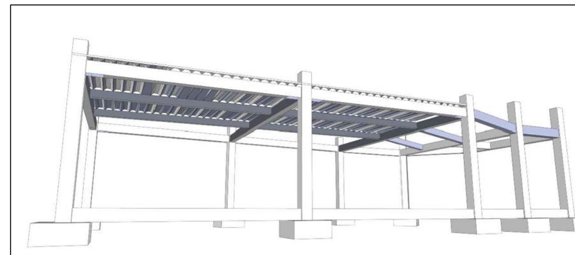
Estructura de las salas de velación mediante columnas de concreto armado y losa reticular de concreto, así como el edificio administrativo mediante losa maciza y castillos de concreto
