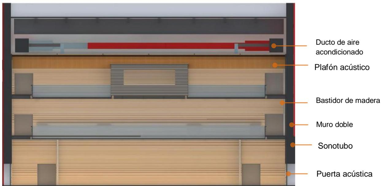
5.7.- Corte. Detalle de localización de elementos acústicos
