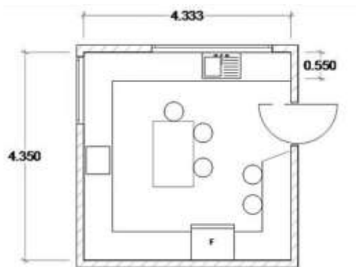
Fig.4, Cocina Residencial; con 18.84 m2 de construcción
