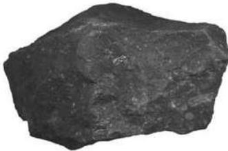
(Imagen 21) **Andesita:** Es una roca oscura, negra a gris-verdosa. De composición intermedia entre el basalto y la riolita, está compuesta de feldespatos, biotita y otros minerales. Se caracteriza por presentar un grano fino.
