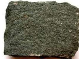
(Imagen 22) **Dacita.-Roca** volcánica rica en plagioclasa y un contenido en SiO<sub>2</sub> entre 63 y 68%. Su temperatura de emisión está comprendida entre 800 y 1,000 °C.
