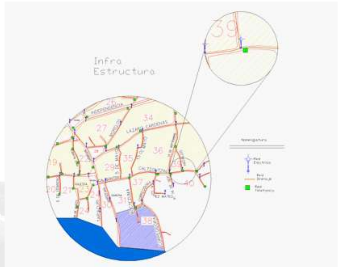
Fig. Plano Infra-Estructura
