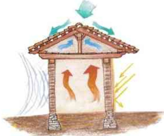
Imagen 7.76 Corte esquemático de una vivienda regional.
