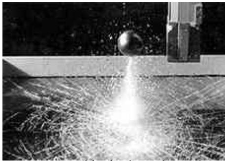
Mapa 1: comportamiento del vidrio laminado cuando es golpeado por una esfera metálica.
