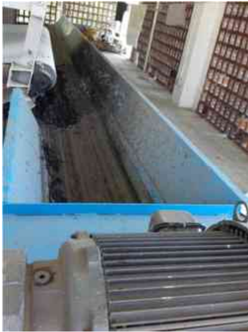
Figura 54. Filtro banda, salida de los lodos deshidratados a la canaleta, fuente: captura autor.
