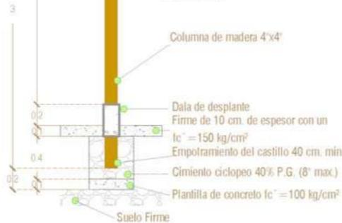
Una vez fraguado la primera capa de concreto se procede ahogar las columnas de madera ubicadas como se especifica en el plano de cimentación. Las columnas quedaran en posición vertical y al nivel requerido, empotrada en el cimiento se colocan clavos de 4" siendo 5 por cada lado, formando una especie de "mechón" ayudando anclar la columna en el cimiento.
