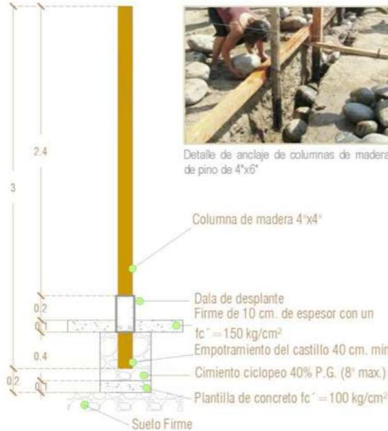
Una vez fraguado la primera capa de concreto se procede ahogar las columnas de madera ubicadas como se especifica en el plano de cimentación. Las columnas quedaran en posición vertical y al nivel requerido; empotrada en el cimiento se colocan clavos de 4" siendo 5 por cada lado, formando una especie de "mechón" ayudando anclar la columna en el cimiento.
