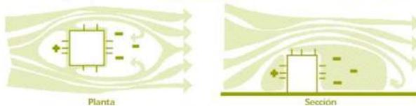
Figura N°\_ 64. Campos de presión y comportamiento del aire alrededor de la edificación. WWW.FAU.UCV.VE.
