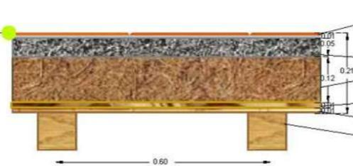
Detalle de Losa Bioclimatica
