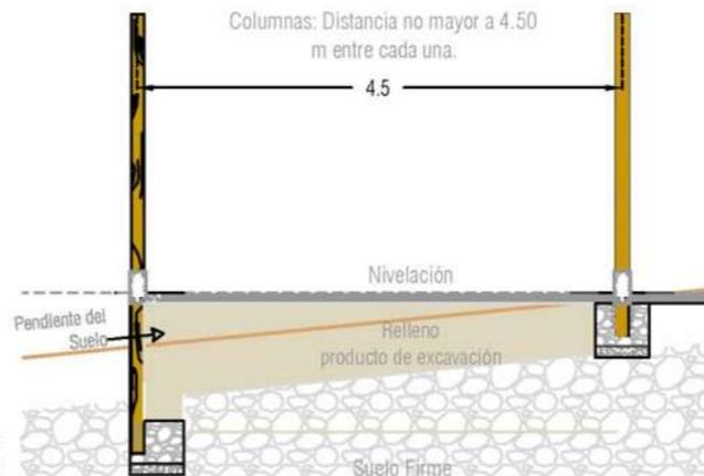
Nivelación.- Para nivelar el terreno en pendiente, se corta el sector más elevado y se va relleno el sector más bajo con producto de excavación, formando una plataforma. El relleno se deberá hacer en capas de 20 cm. debidamente compactado.
