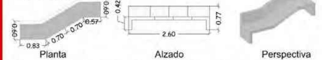
Banca prefabricada de concreto reforzado colada en una sola pieza, acabado natural y anclada al suelo mediante perforacion.
