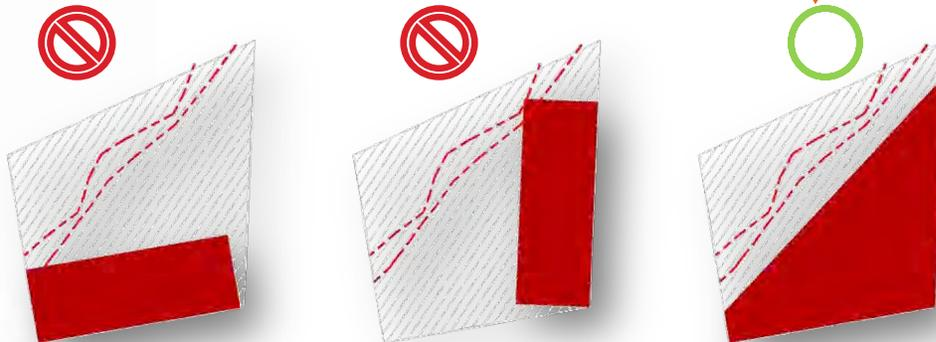
Este edificio se integrará al predio en un acomodo diagonal, de tal manera que se logre el mejor acomodo y el máximo aprovechamiento. Partiendo de que se debe respetar el "derecho de vía" de la falla geológica.
