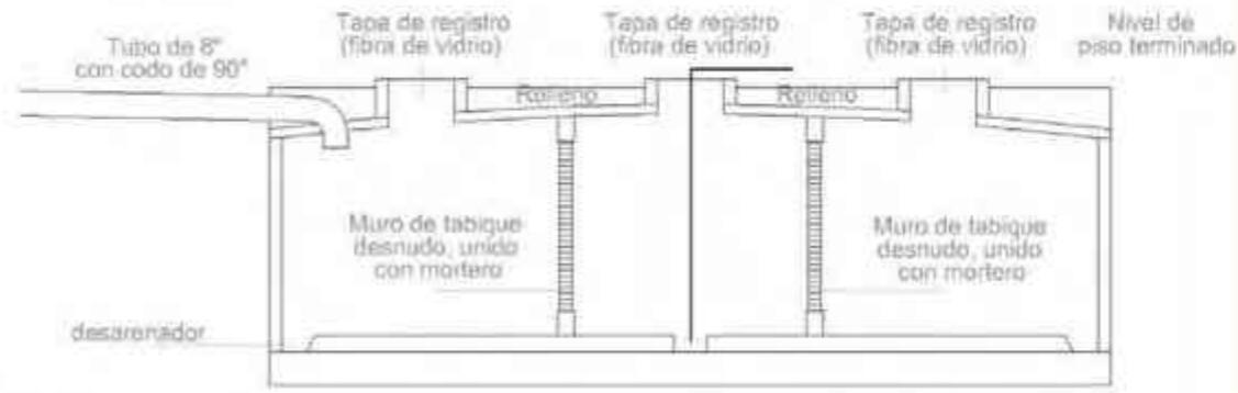
**CORTE DE TANQUE DE FERROCEMENTO**
