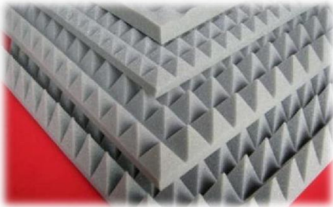
IMAGEN 188. Material absorbente de sonido, compuesto por espuma de resina de melanina; material sólido poroso en su composición, cuya absorción se debe a las propiedades físicas del material. Los prismas generan otro componente extra que permite la absorción de sonido. Imagen obtenida en http://www.alamaula.cl
