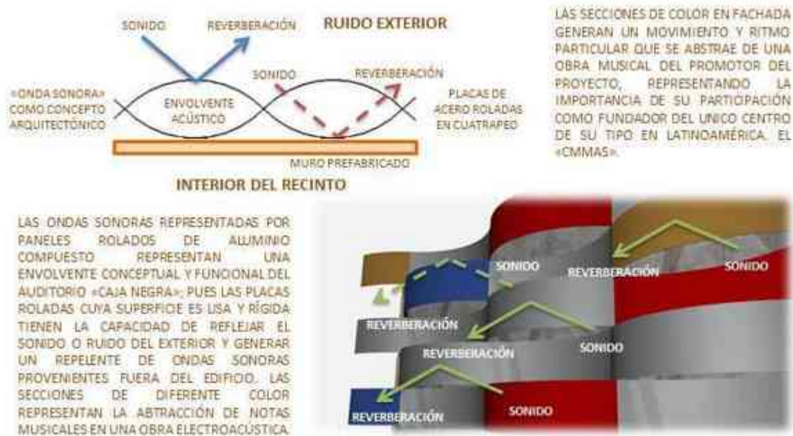
IMAGEN 257. Detalle de la unión Conceptual con lo constructivo y la funcionalidad respecto de reflejar el sonido hacia el exterior que se requiere. Imagen realizada por: Ismael Vázquez Betanzos y Martín Rubio Avalos.
