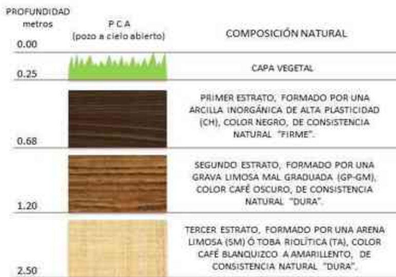
IMAGEN 105. Corte transversal de pozo a cielo abierto (PCA), donde se observa la composición geológica de los materiales que integran el terreno y la profundidad donde se encuentran dichas capas de suelo. Información obtenida por el "Estudio Geotécnico" del Laboratorio de Materiales. Imagen realizada por: Ismael Vázquez Betanzos.
