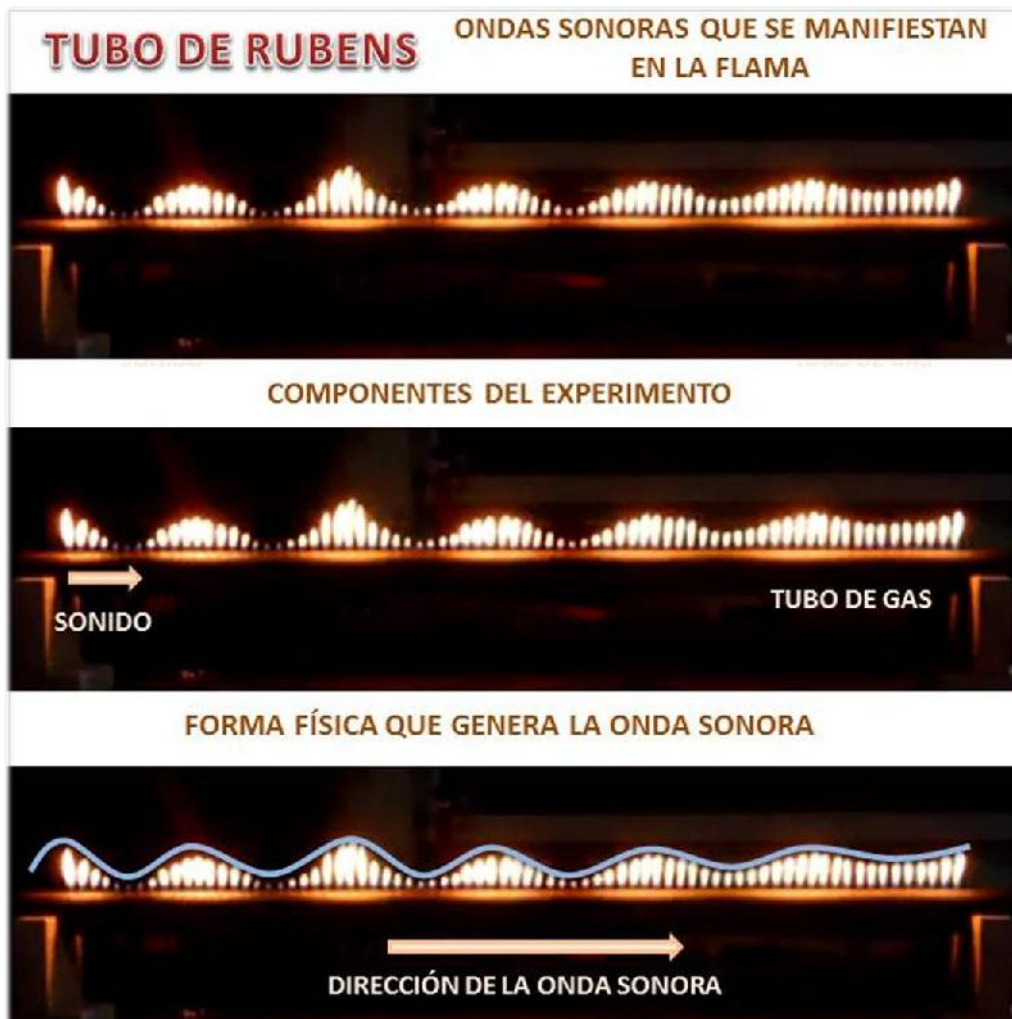
IMAGEN 250. Experimento que demuestra la forma física que poseen las Ondas Sonoras cuando son sometidas a un medio elástico y denso, generando contracciones y dilataciones transversales que viajan en una dirección. Experimento realizado por: Ismael Vázquez Betanzos y Martín Rubio Avalos. Imagen editada por: Ismael Vázquez Betanzos.
