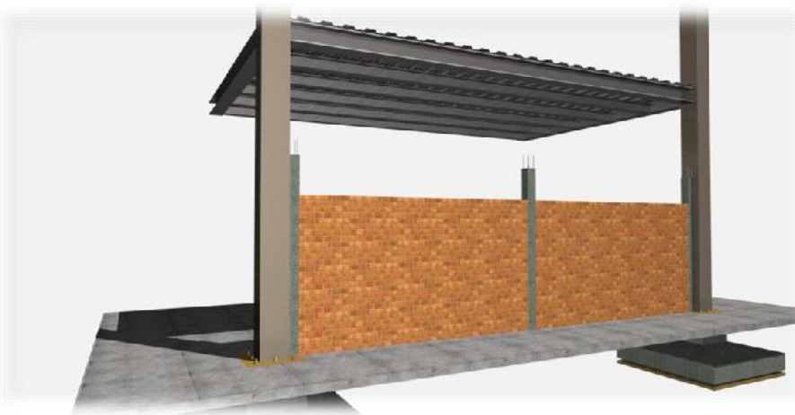
IMAGEN 237. Detalle de albañilería en el sistema constructivo metálico, donde los castillos juegan un papel independiente de las columnas metálicas dejando juntas frías en sus uniones. Imagen realizada por: Ismael Vázquez Betanzos.
