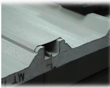
IMAGEN 247. En la imagen superior izquierda se aprecia un detalle constructivo de la sección transversal de prefabricado Multytecho; en la imagen superior derecha se aprecia un detalle de unión de panel con panel por medio de un ensamblaje sencillo por un elemento macho y otro hembra que penetran y se unen, la ceja posterior cubre la junta evitando filtraciones de agua. Imágenes obtenidas en: http://www.panelaislado.com
