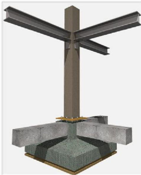
IMAGEN 233. Detalle de la unión de las vigas primarias con la columna metálica; las placas de unión en el lecho bajo de la viga. Imagen realizada por Ismael Vázquez Betanzos. Programa de edición: ArchiCAD Graphicsoft
