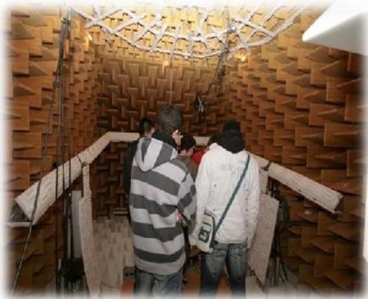
IMAGEN 23. Se muestra el interior de la Cámara Anecoica del IRCAM; espacio para experimentación acústica. Los paneles en el techo y muro cubiertos de fibra de vidrio acuñados diseñados para absorber todo el ruido posible, haciendo que las reverberaciones sean nulas. De tal manera que no hay sonido ni del exterior al interior y viceversa. Imagen obtenida en: http://www.ircam.fr
