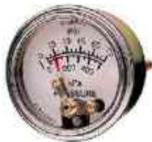
IMAGEN 115. Manómetro, instrumento de medición de presión de agua del Sistema de Riego por Goteo", la aguja mide muestra la presión del líquido a través de la tubería. Información obtenida en: http://www.turiego.es
