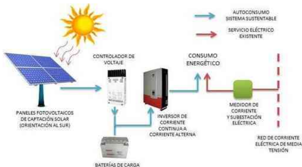
IMAGEN 111. Diagrama Conceptual de Sistema Fotovoltaico de Captación Solar. Información obtenida en el Manual de Prácticas Recomendadas para Proyectos de Sistemas Fotovoltaicos. Imagen realizada por: Ismael Vázquez Betanzos.
