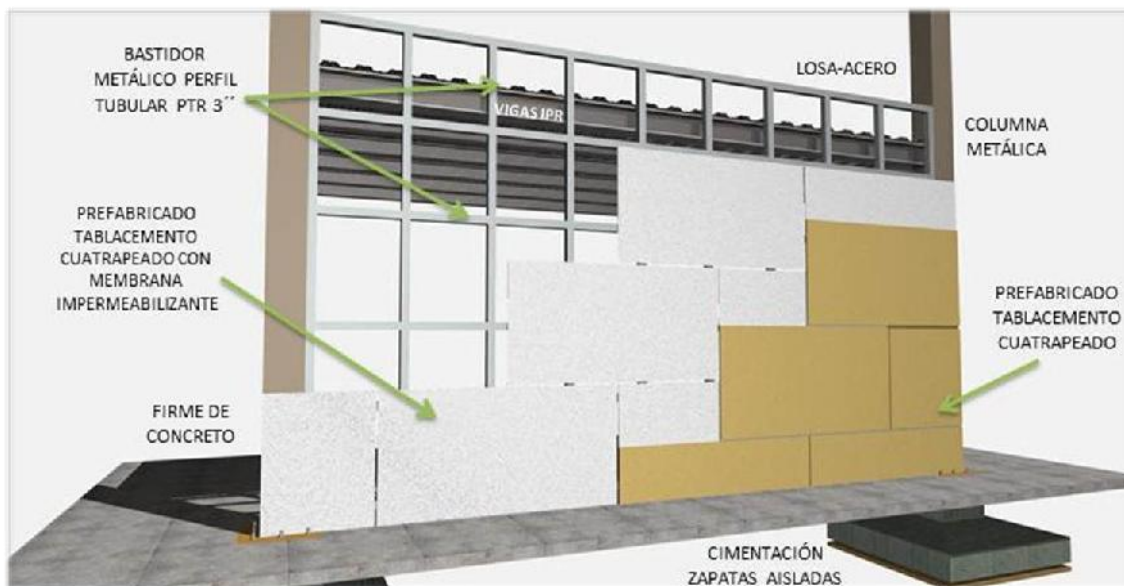
IMAGEN 240. Detalle constructivo de los muros exteriores propuestos para el proyecto arquitectónico; se aprecia el cuatrapeo de hojas prefabricadas de tabla-cemento con membrana impermeabilizante montadas en bastidor metálico a base de perfiles tubulares PTR de 3" y montado a su vez a columnas metálicas. Imagen realizada por: Ismael Vázquez Betanzos. Programa de edición: ArchiCAD Graphicsoft.
