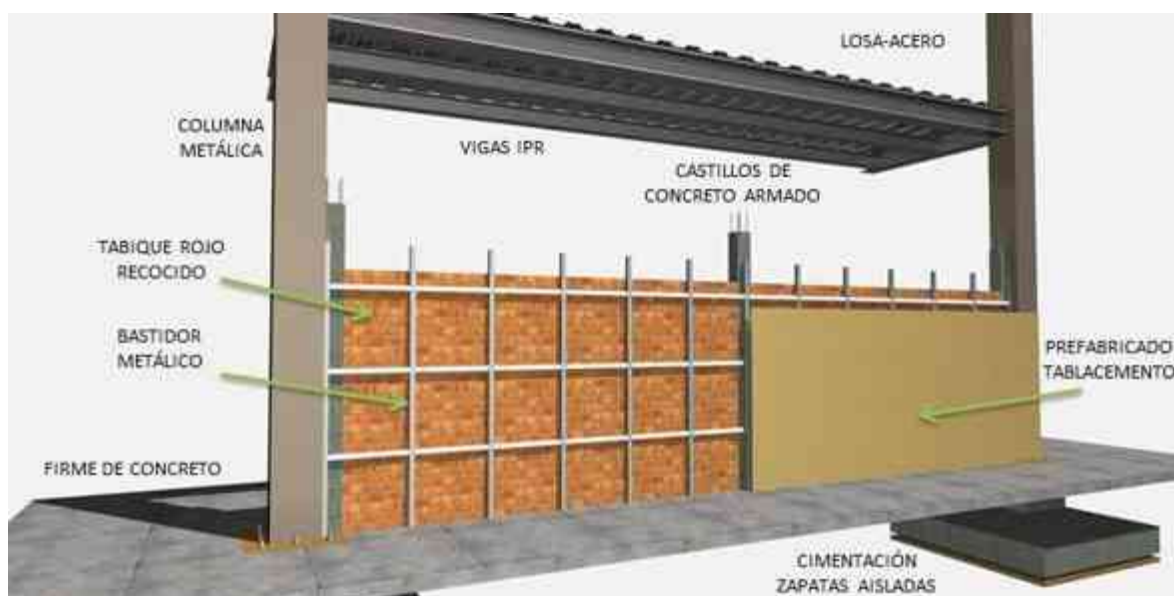
IMAGEN 238. Detalles constructivos conceptuales de las delimitantes exteriores para las áreas administrativa y de residencias de la propuesta arquitectónica. Imagen realizada por: Ismael Vázquez Betanzos y Martín Rubio Avalos. Programa de edición: ArchiCAD Graphicsoft.
