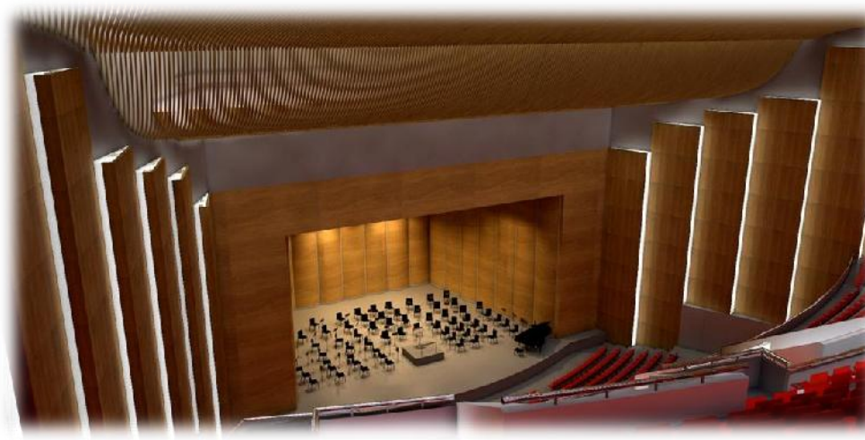
IMAGEN 216. Ejemplo de reflectores en el interior del auditorio de Tepic realizado por la firma de arquitectos DI VECE. Los paneles reflectores en pared muestran una inclinación hacia el público.
