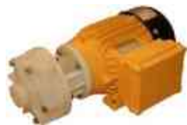
IMAGEN 113. Bomba de acción centrífuga Serie "U" con cierre de anillo deslizante de acción simple; especialmente adecuada para medios con alta viscosidad o cargados con sólidos, cuyo caudal máximo es de 500 lts./min. Y una elevación de 40 metros aproximadamente. Información obtenida en: http://www. http://www.directindustry.es
