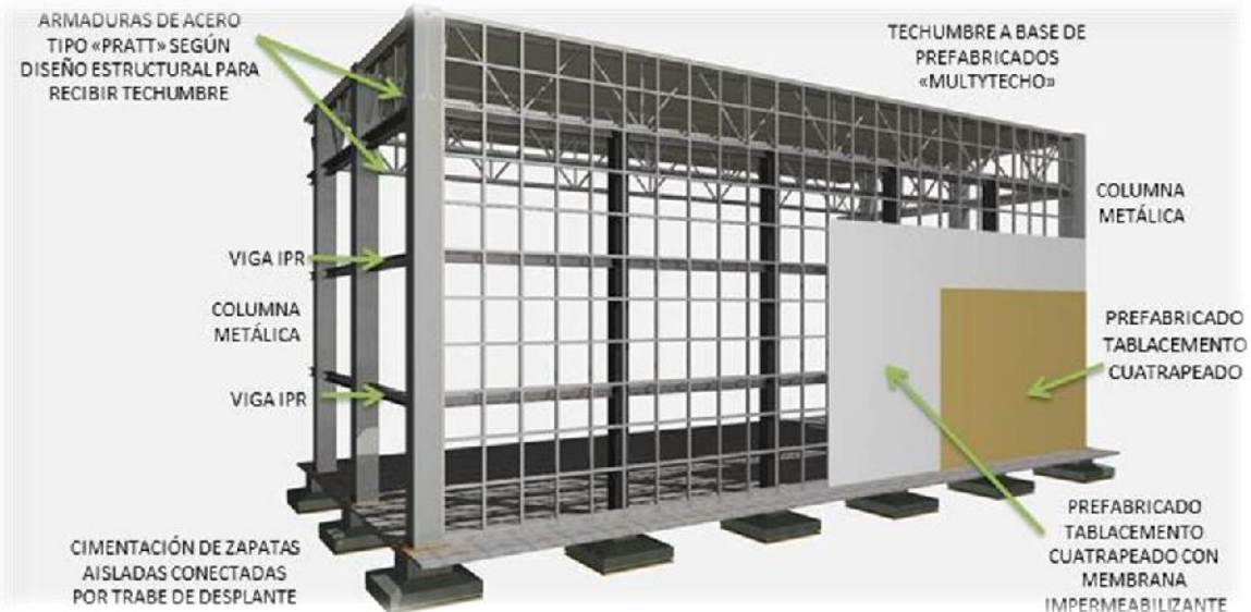
IMAGEN 244. Detalles constructivos de la estructura metálica y de los recubrimientos exteriores del auditorio “Caja Negra”. La propuesta de techumbre para el espacio fue a base del sistema constructivo “Multytecho”. Imagen realizada por: Martín Rubio Avalos e Ismael Vázquez Betanzos. Programa de edición: ArchiCAD Graphicsoft.
