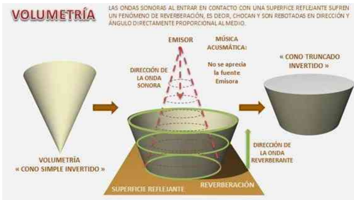
IMAGEN 253. Conceptualización del Cono Simple invertido que se obtuvo cuando se abstrajo la forma geométrica que toma una sección de ondas cuando entran en contacto con una superficie reflejante perpendicular a la dirección del rayo sonoro, sufriendo una reverberación; rebotando las ondas sonoras en una dirección opuesta arrojadas nuevamente al medio de propagación. Abstrayendo la forma se obtiene un “Cono Truncado Invertido”. Imagen realizada por: Ismael Vázquez Betanzos y Martín Rubio Avalos.
