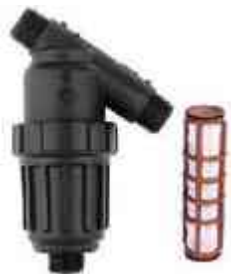
IMAGEN 114. Filtro de malla, que se coloca antes de la conexión con la bomba, donde se almacenan las partículas y sedimentos del agua captada de lluvia; es conveniente su limpieza esporádicamente. Información obtenida en: http://www.riegotec.net
