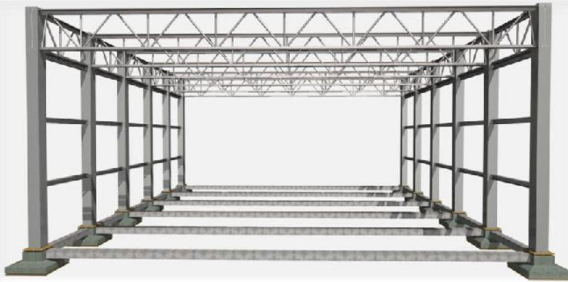
IMAGEN 246. Principio constructivo para el auditorio “Caja Negra”, donde se observan todos los elementos que la componen principalmente. Imagen realizada por: Martín Rubio Avalos. Programa de edición: ArchiCAD Graphicsoft.
