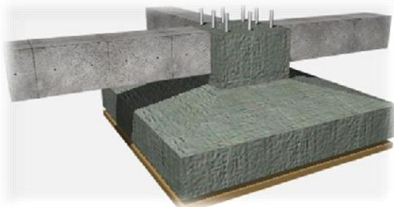
IMAGEN 231. Perspectiva de una zapata aislada con traves de desplante alrededor del dado armado; se aprecian los pernos roscados que están ahogados en el concreto armado y dejan un segmento que ira soldado a la placa metálica. Imagen realizada por: Martín Rubio Avalos. Programa de edición: ArchiCAD Graphicsoft.
