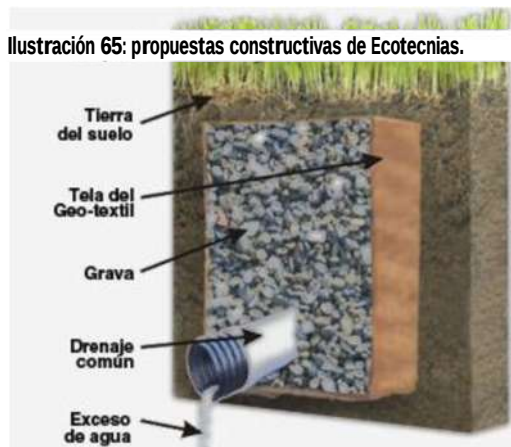
Ilustración 68: ejemplo de drenes para captación de aguas pluviales.
