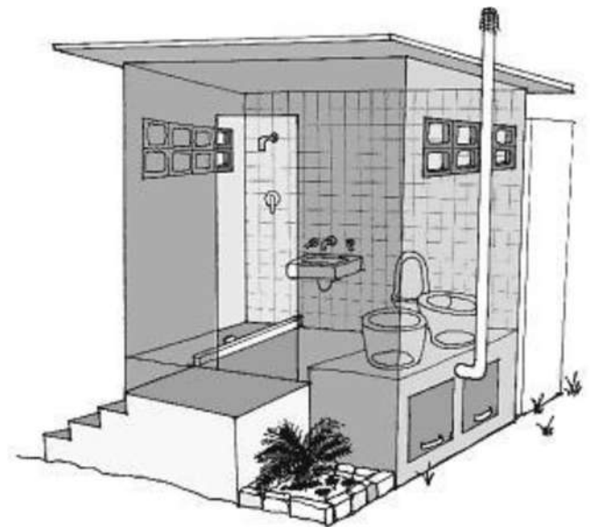
Ilustración 66: Sistema de baño seco, para ahorro de agua.
