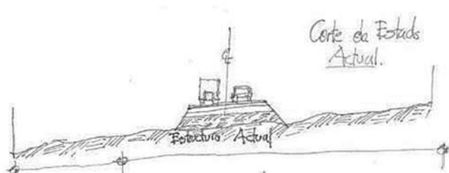
Ilustración 75: Croquis transversal de estado actual de carretera
