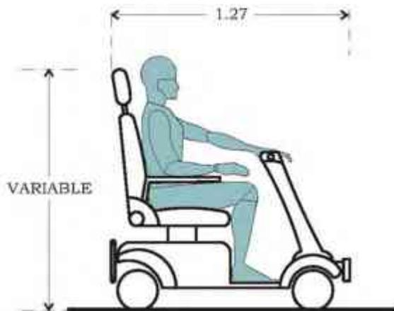
Figura No. 4 Dimensiones de silla con motor
