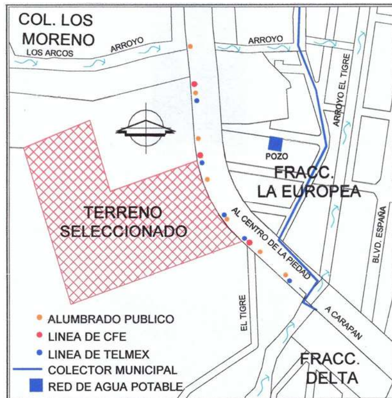
Imagen 23. Infraestructura de terreno elegido.
