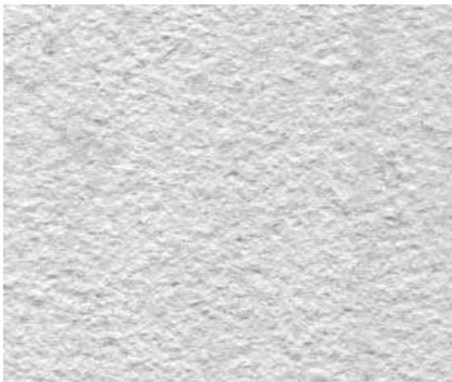
Ilustración 73 Acabado abujardado manualmente con bujarda. http://www.kfqnaturalstone.es/asistencia-t%C3%A9cnica/texturas/
