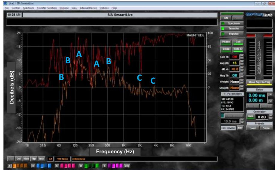
Fig. 171, Medición cerca eje, Smaart live
