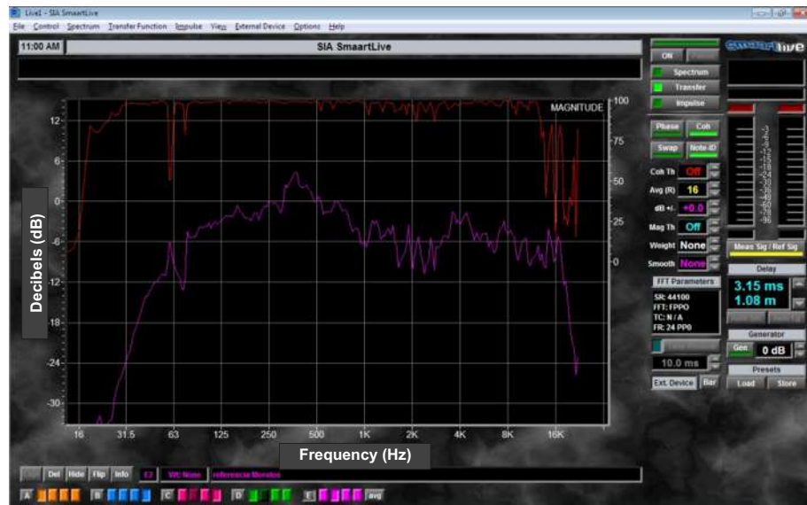
Fig. 143, Medición referencia, Smaart live
