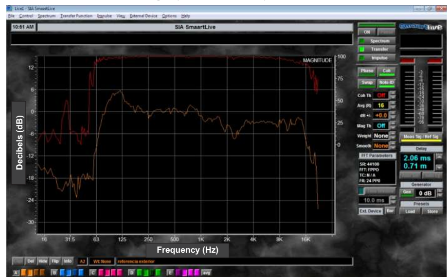
Fig. 170, Respuesta de frecuencia de referencia, Smaart live
