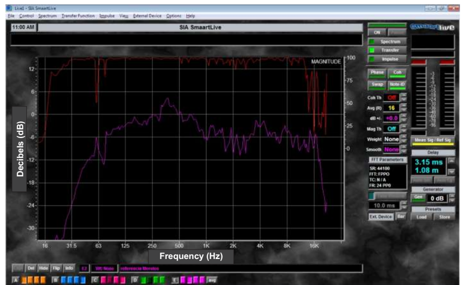
Fig. 133, Respuesta de frecuencia de referencia, Smaart live
