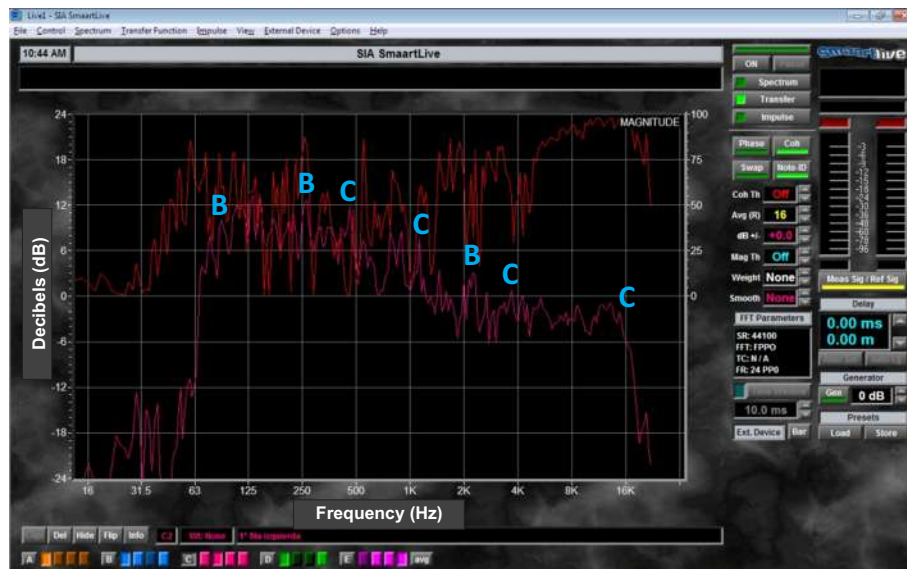
Fig. 176, Medición cerca pared, Smaart live
