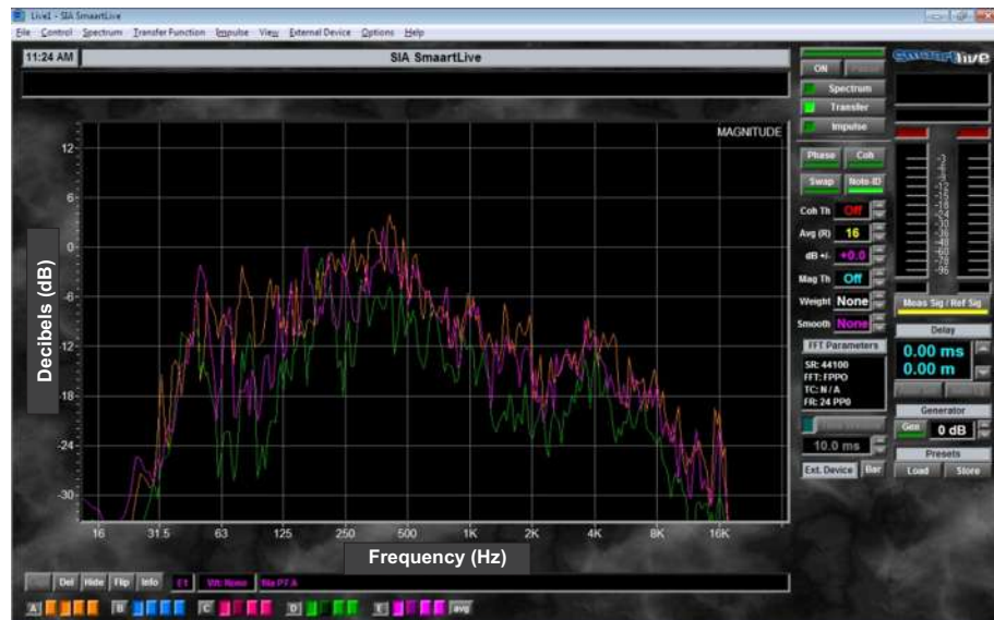
Fig. 142, Medición promedio pared, Smaart live
