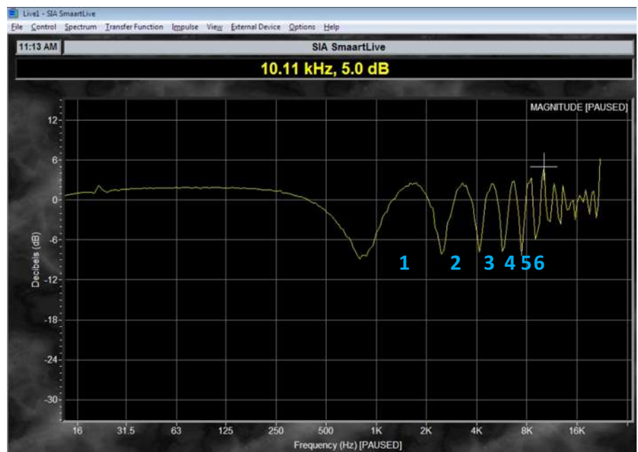
Fig. 312, Respuesta de Frecuencia, onda tardía 6 ciclos, Smaart Live
