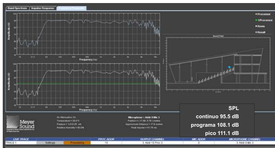
Fig. 233, Predicción respuesta de frecuencia micrófono fondo, Sim 3 virtual
