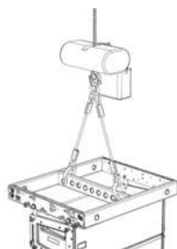
Fig. 253, Montaje parrilla a polipasto, Meyersound
