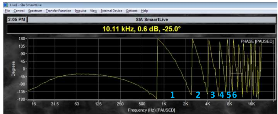
Fig. 311, Respuesta de Fase, 6 ciclos, Smaart Live
