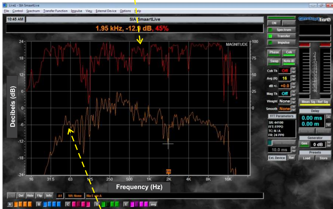
Fig. 118, Medición de respuesta de frecuencia y coherencia, Smaart live
