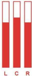
Fig. 267, Nivel en mezcladora sin saturación
