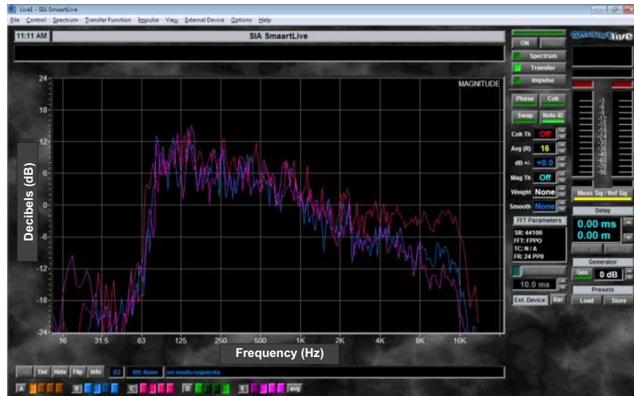
Fig. 179, Medición promedio pared, Smaart live
