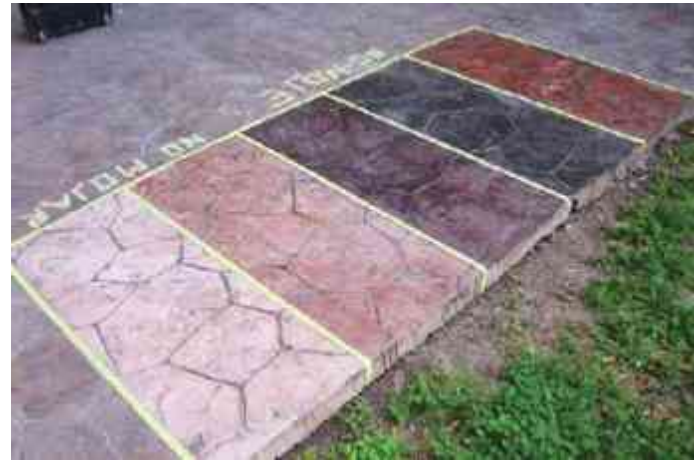
Fotografía 23 Diseños en concreto estampado.
