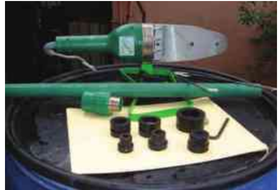
IMAGEN 108: PISTOLA DE TERMOFUSIÓN Y ACCESORIOS TOMADO DE: HTTP://WWW.ROTOPLAS.COM/TUBOPLUS/
