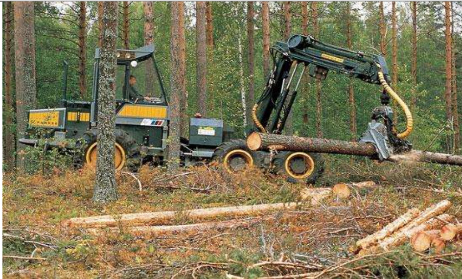
Imagen 14. Extracción mecanizada de madera en rollo largas dimensiones.
