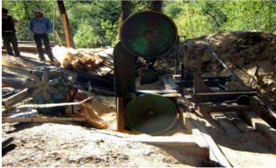
Imagen 4. Aserradero con carro de empujón en el estado de Michoacán.
