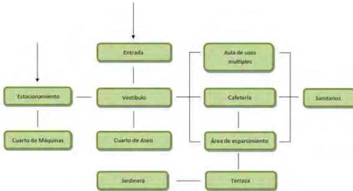
Gráfica 24. Diagrama de Funcionamiento II. Diagrama de funcionamiento para el área de servicios generales. Gráfica del autor.
