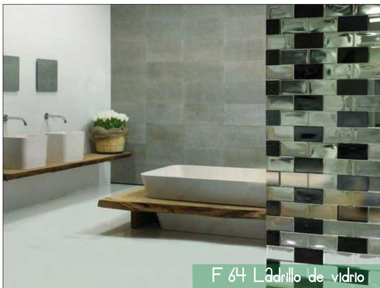
En efecto, esta clase de resistencia no sólo garantiza a la estructura estabilidad y resistencia, sino también un bajo paso de radiaciones térmicas, limitando así el calentamiento de objetos situados en los ambientes protegidos por la pared de ladrillos de vidrio.
