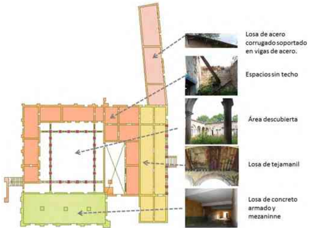
Fig. 12. Localización de columnas y contrafuertes. MCHB.
