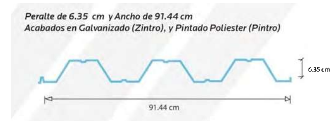
Figura 7.10 Sección tipo losacero Fuente: Manual Técnico losacero
