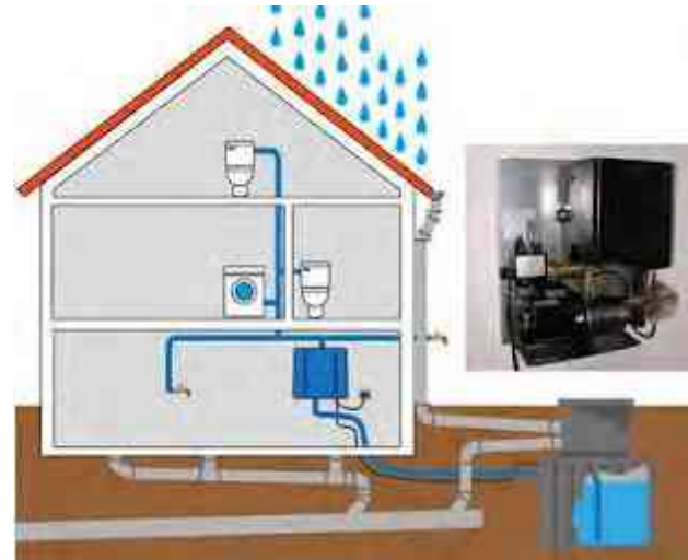
Fig 47. Sistema subterráneo de recogida de aguas de lluvia con sistema de bomba/ Fuente: http://icasasecologicas.com/casas-bioclimaticas-iv-aprovechar-el-aqua-de-lluvia/
