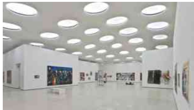
Fig 48. Galería interior, Museo Stadel, Fráncfort, Alemania, - luz natural al interior mediante claraboyas traslucidas/ Fuente: http://www.medioambiente.org/2012/03/museo-stadel-tejado-verde-y-luz-natural.html
