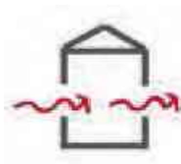
Imagen 66: Esquema de ventilación cruzada, anónimo. Diciembre 2012
