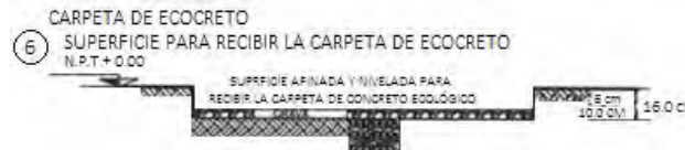
Fig 36. Colocación de concreto ecológico Fuente: http://www.concretopermeable.com/
