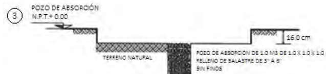
Fig 33. Pozo de absorción
