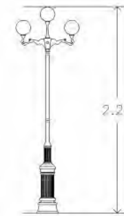
POSTE TRIPLE BELAGIA PFT-3360-3/AI CON FAROL FTL-6005/BA MARCA TECNO LITE, 100-127 V COLOCACIÓN EN AREA DE PERGOLAS.
