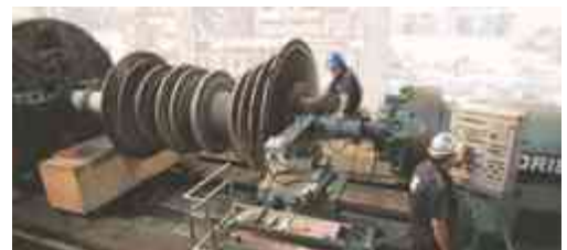
Foto No.10: Proceso de elaboración de turbina para la industria azucarera. Fuente: Carlos Hahn Ramírez.
