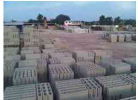
Imagen No.17: Fabricación y almacén de bovedilla en INRAPRESA. Fuente: http:// www.bing.com/images/search?q=inrapresa
