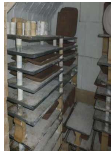
Imagen 5: horno de gas LP, para la cocción de alfarería de alta temperatura, alfarería especializada, foto tomada por: Francisco Reyes Ortiz
