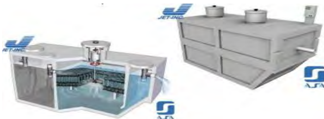
Imagen 19 detalle interior y exterior planta tratadora de aguas residuales JET.
