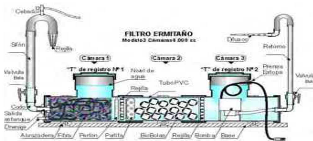
Diagrama 1. Partes y función de filtro ermitaño.
