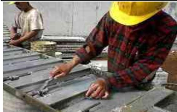
cada seis meses se realiza una limpieza a detalle para garantizar la durabilidad y correcto funcionamiento de los moldes.
