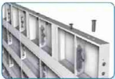
**Paso 2** Se monta la UML de 5 cm sobre el panel, se inserta el pin y se fija con la cuña.
