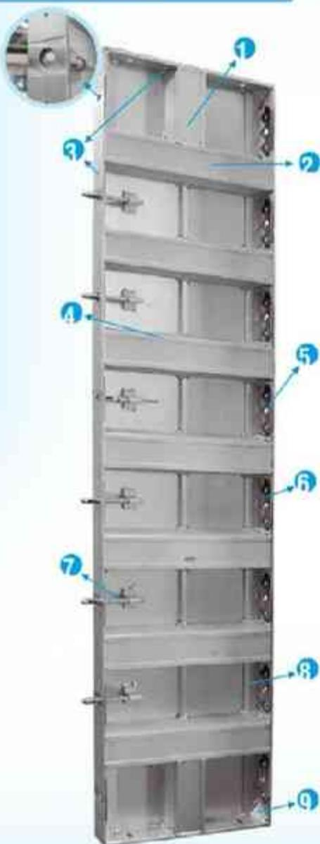
El panel de muro es fabricado con perfiles de aleación de aluminio de la serie Magnesio-Silicio, temple 6 y/o con lámina de aluminio de la serie Magnesio de espesor 3,2mm con tratamiento de temple de endurecimiento por deformación, para incrementar sus propiedades y llevarlo a su condición de dureza total.
