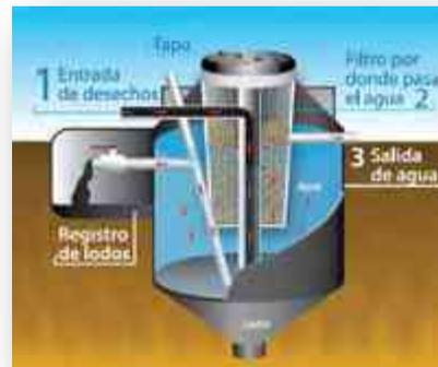
Fig. 47 Funcionamiento del biodigestor. Imagen: [http://www.rotoplas.com/assets/files/gobierno/GiaBiodig\\_Sept2012.pdf](http://www.rotoplas.com/assets/files/gobierno/GiaBiodig_Sept2012.pdf)
