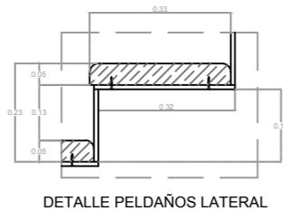
UNIÓN DE PELDAÑOS DE MADERA A VIGAS METÁLICAS
