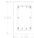
Trabe de concreto armado con 6 var. N° 6 (3/4") techo inferior & var. N° 4 (1") techo superior 2 var. N° 4 (1") a la mitad de la trabe y Est. #2 1/2 @ 15cm en zona de confin. y @ 20cm en z. central  $F_c = 250 \text{ kg/cm}^2$   $F_y = 4,200 \text{ kg/cm}^2$
