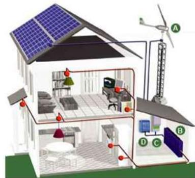
A.- AEROGENERADOR: TRANSFORMA LA FUERZA DEL VIENTO EN ELECTRICIDAD
