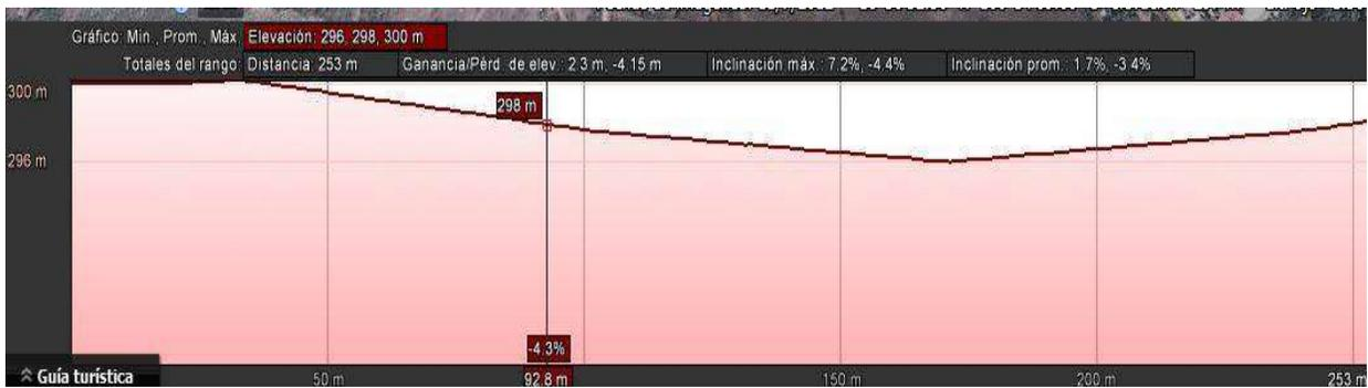
Corte topográfico del terreno obtenido en google earth, perfil de elevación. El terreno fue nivelado para usar de estacionamiento, el corte muestra su topografía original.
