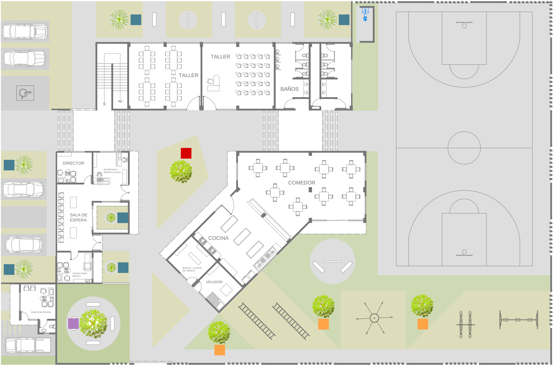
PLANTA ARQUITECTÓNICA DE CONJUNTO
