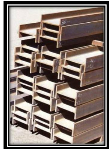
**Figura 69.** Vigas IPR de Acero
