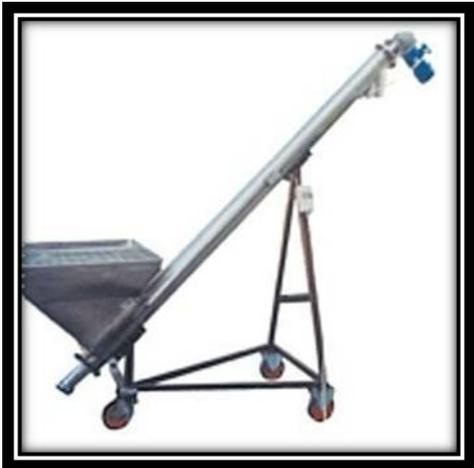
**Figura 19.** Transportador de gusano o tornillo.
