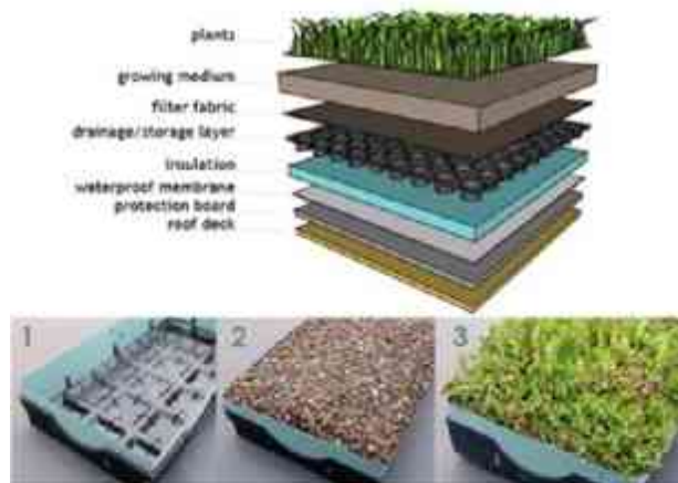
3.4.5 Sistema de azotea verde por Partes
