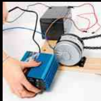
5- Esa electricidad se convierte de CC a CA por un inversor para que pueda alimentar los aparatos regulares.
