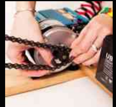
3- Una segunda cadena de la bicicleta se extiende desde la corona trasera hacia atrás para girar el motor.
