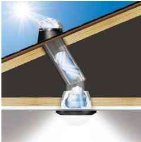
Imagen 48. Detalle del funcionamiento del Solatube; como se observa se puede implementar dicho sistema en techos inclinados así como en planos. Fuente: http://www.solarcentre.ca/solutions/solatube/
