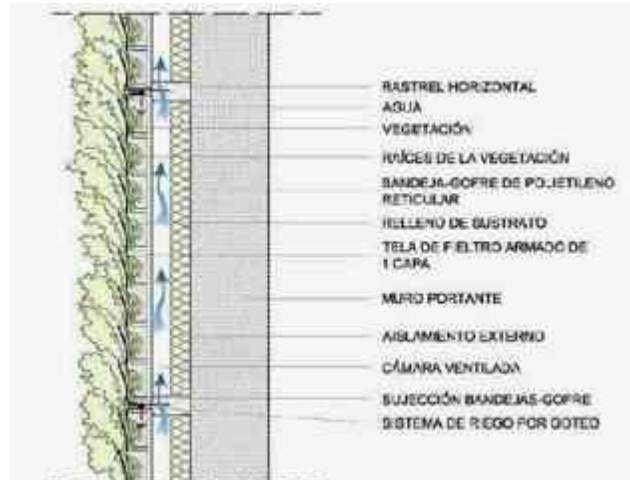
Imagen 43. Estructura general de Jardín vertical con sustrato ligero desmontable (bandejas). Fuente: http://www.taringa.net/posts/ecologia/15355917/Muros-Verdes--EcoArq-Manualidad.html .
