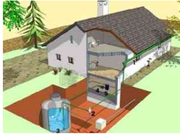
Imagen 50. Partes que conforman el sistema de recolección de agua pluvial: 1.Recolección de agua de lluvia, tanto en cubiertas como en superficies pavimentadas; 2.Filtro; 3.Déposito para almacenar el agua; 4.Bomba de impulsión y 5.Sintema de gestión control. Fuente: http://blog.is-arquitectura.es/nuevas-tecnologias-en-viviendas/reciclaje-de-agua/recogida-de-aguas-pluviales/
