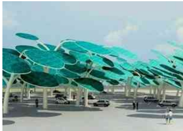
Imagen 45. Vista exterior del bosque solar. Los árboles solares están especialmente diseñados para cambiar de dirección los paneles solares y aprovechar al máximo la incidencia de luz solar. Fuente: http://inhabitat.com/solar-forest-charging-system-for-parking-lots/
