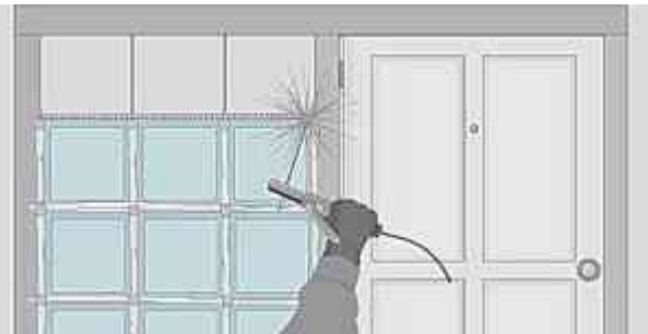
Imagen 40. Varillas corrugadas horizontales de 8mm montadas según especificaciones del muro.
