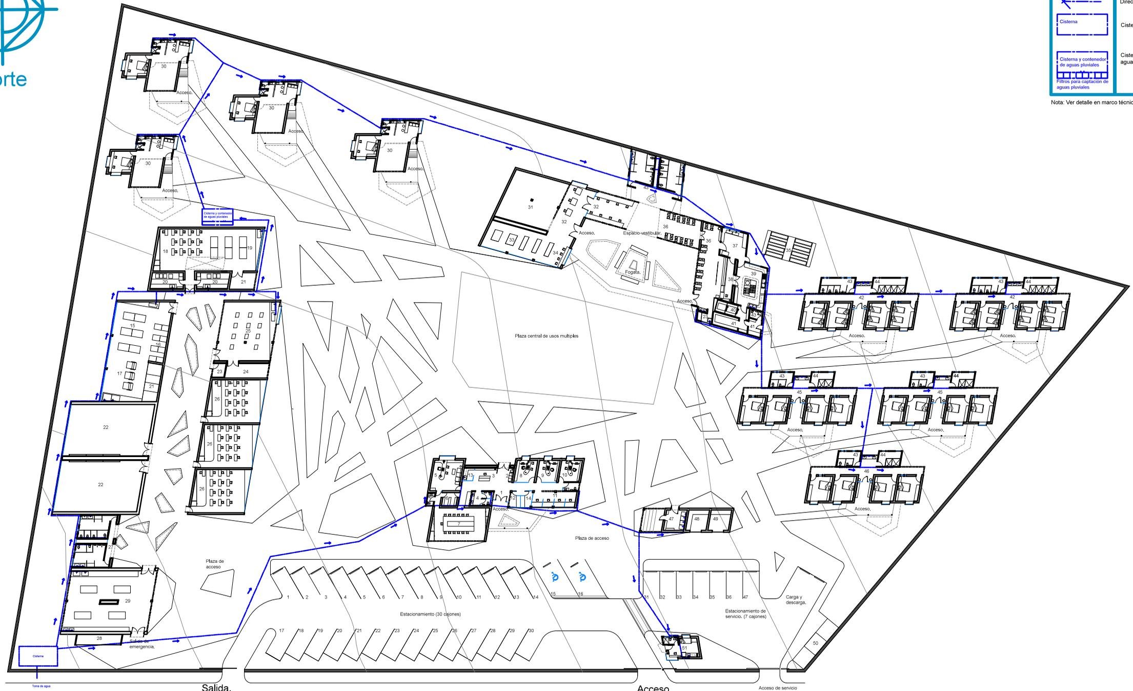
Planta de conjunto - Instalación hidráulica
