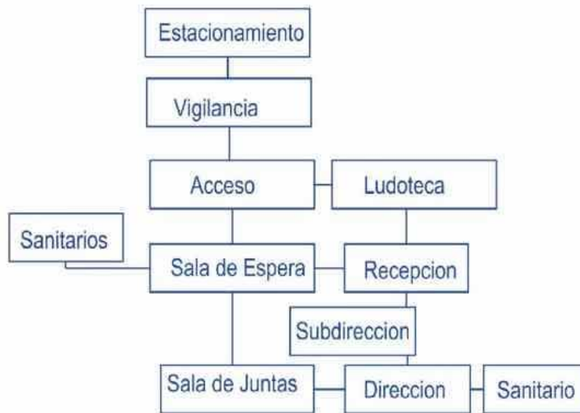
Imagen 35. Diagrama de Funcionamiento Particular de Dirección| R. Maciel V.
