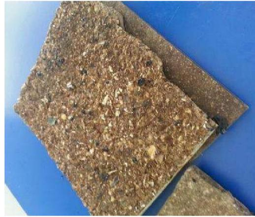
Figura 18. Imagen en donde se muestra la ebullición del plástico.
