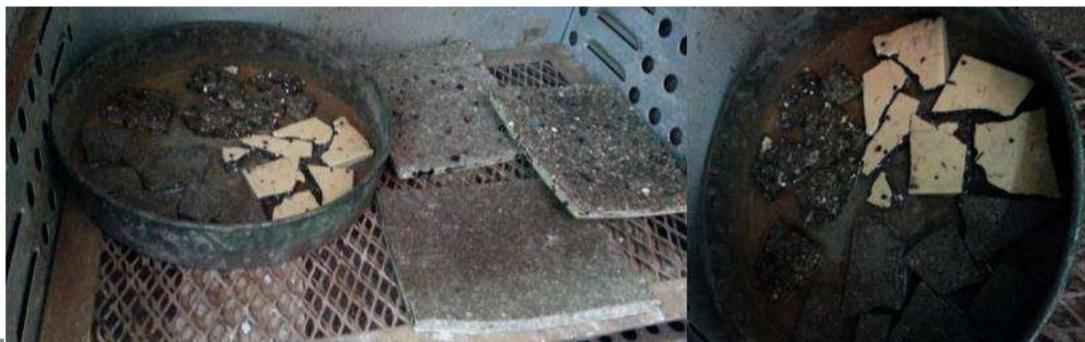
Figura 16. Deformaciones sufridas como consecuencia de someter las placas a temperatura durante un periodo prolongado.
