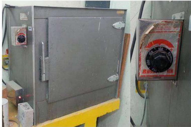
Figura 15. Horno donde se realizó la prueba de termofluencia a 100°C.
