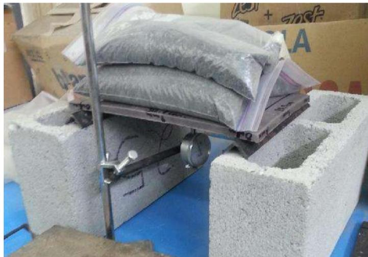
Figura 11. Placa con carga de 5 kg uniformemente distribuidos.
