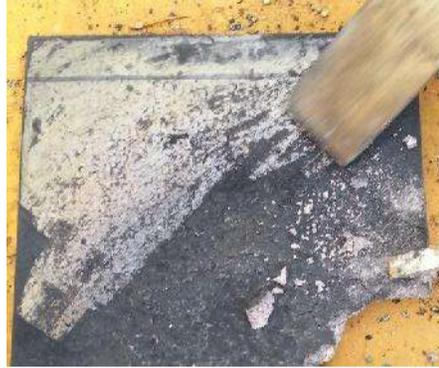
Figura 27. Placa limpia después de estar en contacto con el fuego durante 6 minutos aprox.
