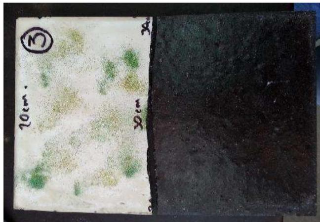
Figura 6. Fractura presentada en el panel No. 3.
