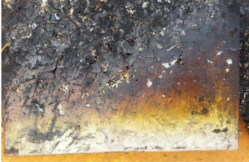
Figura 23. Imagen que muestra los cambios en la coloración de la placa polimérica.
