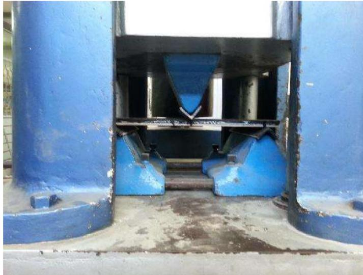
Figura 4. Colocación de los apoyos a cada 2.5 cm y la carga puntual al centro.
