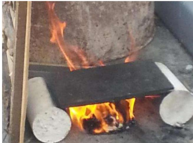
Figura 22. Placa No. 9 con acabado liso en contacto directo con el fuego.
