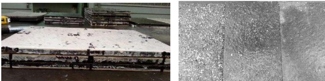
Figura 3. Placas sometidas a la prueba de módulo de ruptura.
