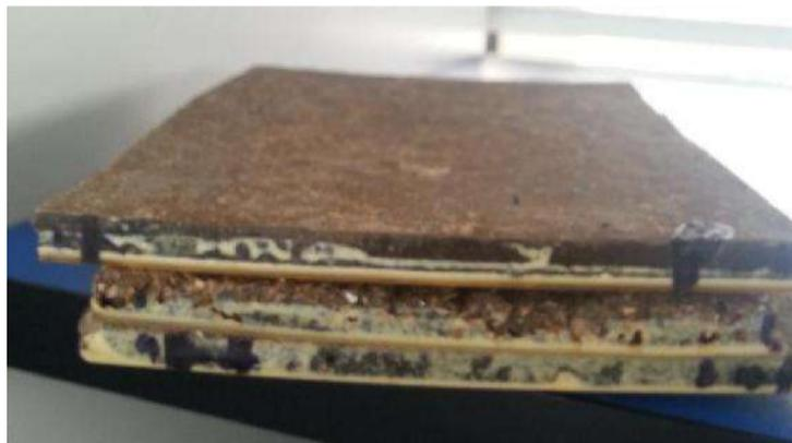
Figura 19. Imagen en donde se muestra la curvatura adquirida por las placas.
