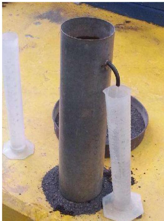
Figura 14. Picnómetro arrojando agua en la probeta.
