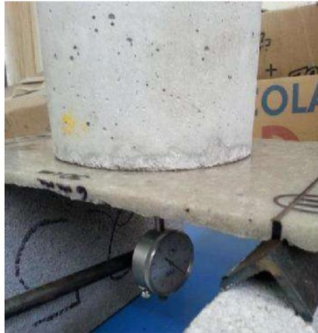
Figura 10. Placa No. 11 con carga aplicada de 8 kg.
