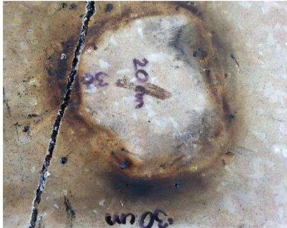
Figura 21. Daño ocasionado en la primer placa sometida a ignición. (Placa No. 15 de la Tabla 2)
