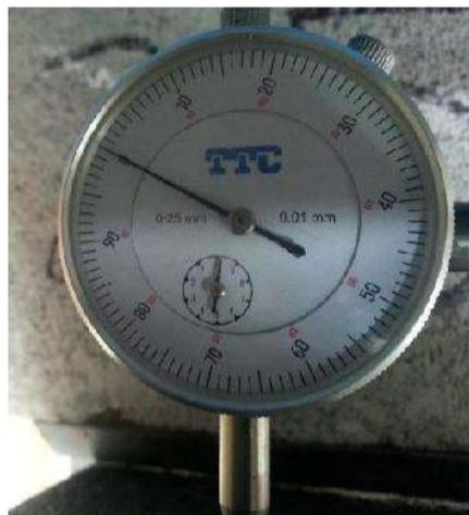
Figura 9. Micrómetro en cero al iniciar cada prueba.
