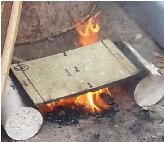
Figura 24. Placa No. 6 con acabado rugoso en contacto directo con el fuego.
