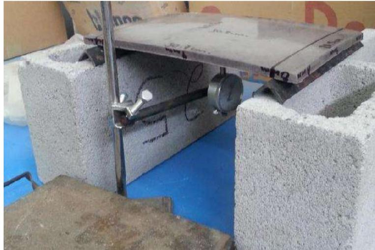
Figura 8. Colocación de las placas en los apoyos.
