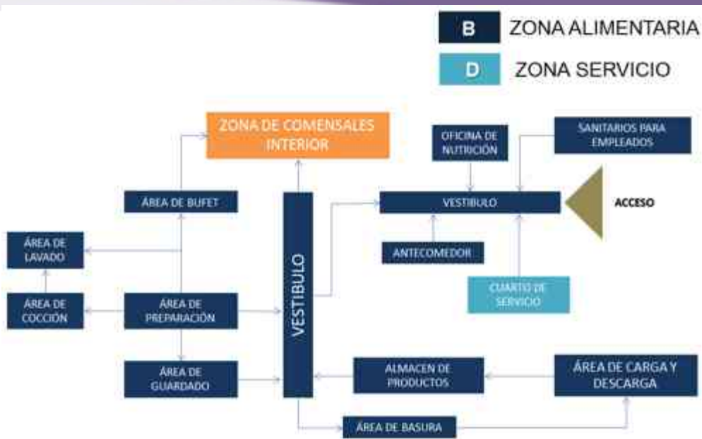
Diagrama de funcionamiento particular de la zona de Alimentaria y de Servicio. Editada por RGV.
